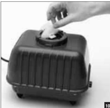
2. Nehmen Sie das Filtermedium aus der Durchlüfterpumpe (Abb. 10) und spülen Sie es gründlich mit kaltem Wasser.
