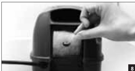
3. Replacer la masse filtrante dans la cavité du filtre.
