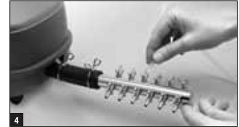
5. **PRECAUCIÓN:** Se debe tener cuidado durante la instalación para impedir el sifoneo del agua fuera del estanque a través de la manguera de aire, ya que podría dañar la bomba.
